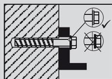
2. Sollte nach der erfolgten Montage zum Ausgleich eine Unterfütterung notwendig sein, ist dies mit den Betonschrauben BSZ ( $\varnothing$  8 – 14 mm) um bis zu 10 mm möglich.
