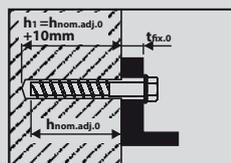
1. Um eine nachträgliche Adjustierung vornehmen zu können, muss die Betonschraube mindestens um 10 mm tiefer als die nominelle Einschraubtiefe eingeschraubt werden. Dies muss bereits bei der Wahl der Betonschraubenlänge berücksichtigt werden.
