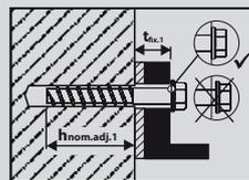
4. Nach dem Anbringen der Unterfütterung erfolgt erneute Befestigung des Anbauteils entsprechend den Montagevorschriften.
