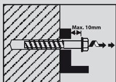
3. Hierzu darf bei der erstmaligen Adjustierung die Betonschraube um maximal 10 mm zurück gedreht werden.
