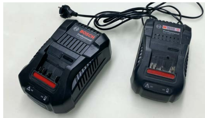
Leicht zu verwechseln: links ein Lader für 36 Volt Akkus, rechts ein Ladegerät für 18 Volt Akkus
