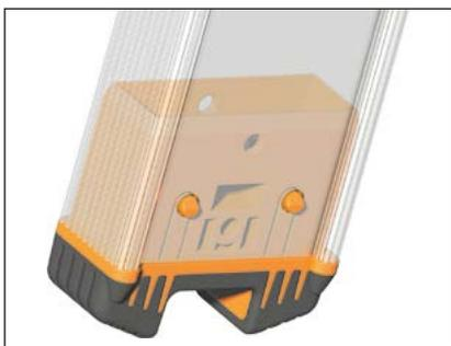
Mit dem Combigrig-Leiternfuß können sogar ältere TOPIC-Leitern von Layher nachgerüstet werden. Dazu muss der Niet ausgebohrt und der Leiternfuß mit einem neuen Niet gesichert werden, da Löcher für die beiden Sicherungszapfen fehlen.
