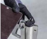
Die Plattform einhängen und dann durch einsetzen des unteren Sicherungssteckers sichern.
